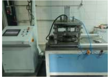
Стенд для испытаний крутящего момента двухсекционного маховика
