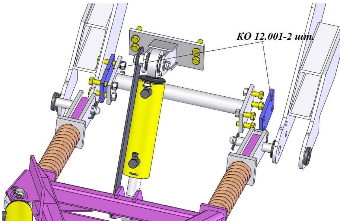
**Изменения: Фиксатор (рис.1) КО 08.000 заменен на новый фиксатор (рис.2)**
